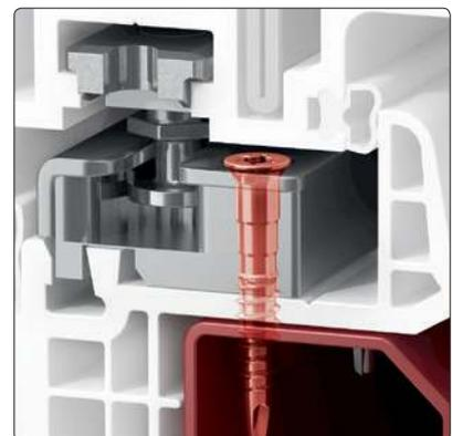
**Sicherheitsschließteil mit Stahlkern verschraubt** | der verstärkte Rahmen leitet die Kräfte in das Mauerwerk ab.
