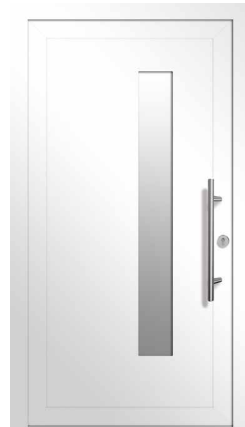
Typ A01230 | Einsatzfüllung | Verkehrsweiß RAL 9016 | Stangengriff S 1020, 600 mm | Edelstahl-Rundrosette | Ornamentglas Satinato | Lichtausschnitt 170 mm x 1400 mm
